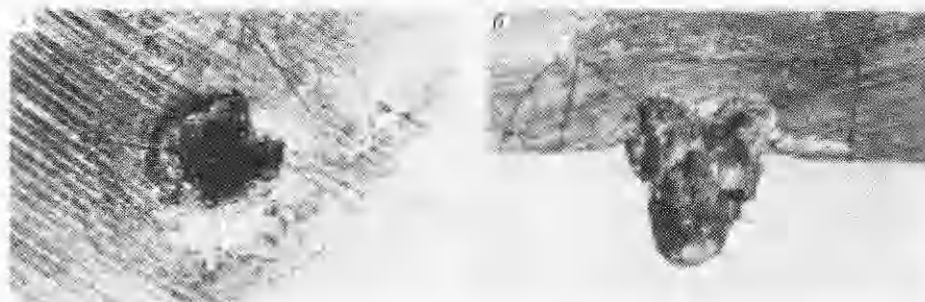
Рис. 7. Вид сверху (а) и поперечный разрез (б) преграды ( n = 4 , R = 0 , d = 94 мм, L = 108 мм).
