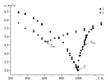
Puc. Температурная зависимость коэффициента температуропроводности стали ЧС-139. 1 — нагрев, 2 — охлаждение;  $T_C$  — температура Кюри,  $T_{MA}$  — температура фазового перехода мартенсит—аустенит,  $T_{AM}$  — температура фазового перехода аустенит—мартенсит.
