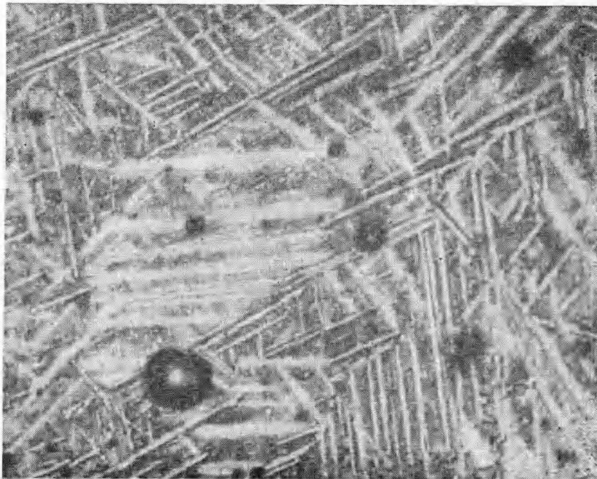
Рис. 1. Следы пластической деформации на поверхности кристалла W_2C .
