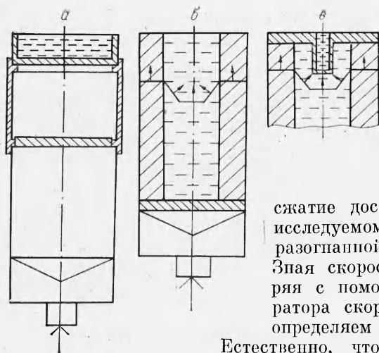
Рис. 1. Экспериментальные сборки для исследования пересжатой детонации.
