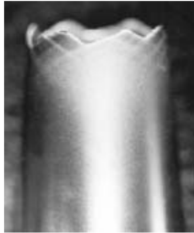
Рис. 5. Направления разрушения на образцах из стали 12ХНЗА
