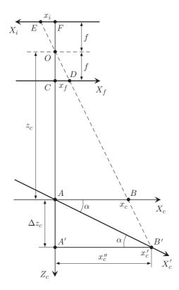
Puc. 1. Геометрическая схема перспективной проекции с параллельным и непараллельным расположением исследуемой поверхности
