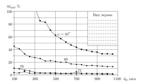
Puc.~6.~ Графики зависимости относительной погрешности величины смещения экранов  $\delta d_{\rm rnd}$  от величины реального смещения  $d_0$  при различных углах  $\alpha$
