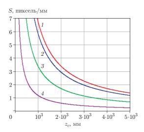
Puc. 4. График зависимости пространственного разрешения изображения от расстояния до исследуемой поверхности при f=50 мм,  $z_c=2$  м, a=7,4 мкм (значения для кривых, как на рис. 3)
