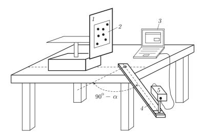
Puc.~5.~ Схема экспериментальной установки: 1 — устройство смещения фонового экрана, 2 — фоновый экран, 3 — персональный компьютер с программным обеспечением, 4 — устройство поворота камеры 5 — цифровая камера
