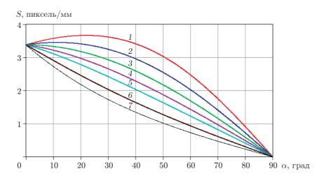
$Puc.\ 2.$  График зависимости пространственного разрешения изображения от угла наклона исследуемой поверхности к плоскости изображения при f=50 мм,  $z_c=2$  м, a=7.4 мкм ( $x_c'=-400$  (кривая 1), -200 (2), 0 (3), 200 (4), 400 (5), 1200 мм (7),  $x_c''=800$  мм (6))
