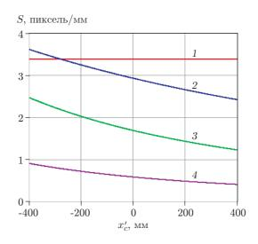
Рис. 3. График зависимости пространственного разрешения изображения от координаты на исследуемой поверхности при f=50 мм,  $z_c=2$  м, a=7,4 мкм ( $\alpha=0$  (кривая 1), 30 (2), 60 (3), 80° (4))
