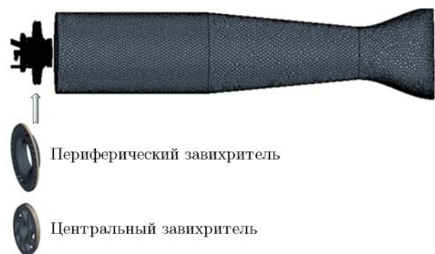
Рис. 2. Расчетная сетка для гидродинамической модели газотурбинной камеры сгорания
