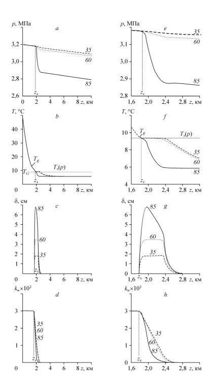
$Puc.\ 2.$  Изменение во времени профилей давления  $(a,\,e)$ , температуры  $(b,\,f)$ , толщины гидратного слоя  $(c,\,g)$  и влагосодержания  $(d,\,h)$  по всей длине трубопровода (a-d) и вблизи участка с максимальной толщиной газогидратного слоя  $(e,\,h)$ .
