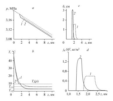
*Рис.* 5. Влияние температуры грунта на процессы, протекающие в трубопроводе. Линии 1 и 2 соответствуют температуре грунта  $T_G$  = 3 и 6 °C.
