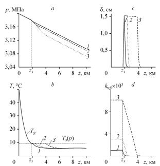
*Рис.* 4. Влияние величины влагосодержания на входе в трубопровод  $k_{w0}$  на процесс гидратообразования.
