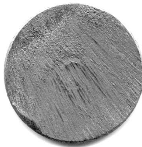
Рис. 2. Вид образца, вырезанного из зоны III, после шлифования
