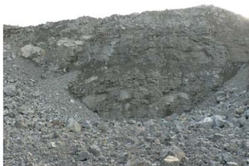
Рис. 2. Состояние массива пород в карьере до ( а — фрагмент фотореалистичной модели подготовленного к взрыву борта) и после массового взрыва борта ( б — фотография, в — фотореалистичная модель после сканирования взорванной массы с выделением цепочки крупногабаритных блоков линейным размером более 0.7 м)
