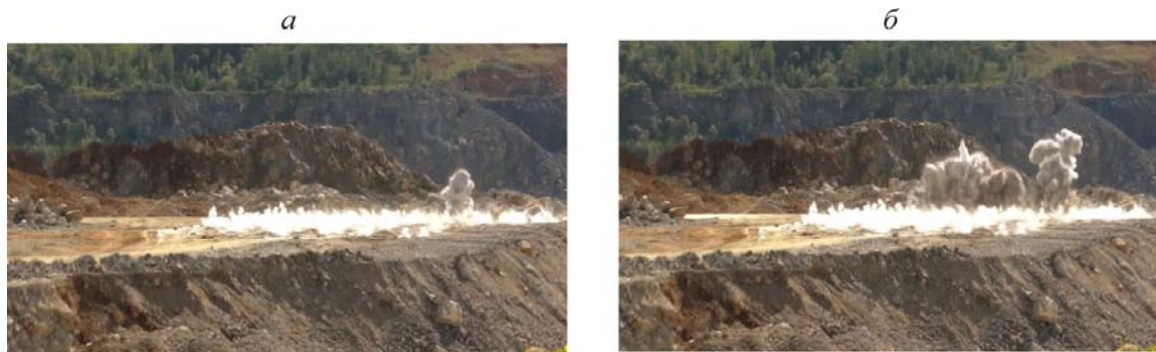
Рис. 5. Последовательные взрывы первой (а) и второй (б) групп скважинных зарядов, зафиксированные с помощью скоростной фотосъемки с частотой 50 кадров в секунду. Интервал между событиями на видеокдрах составляет 20 мс, интервал между подрывом первого скважинного детонатора и взрывом первой группы скважин 500 мс
