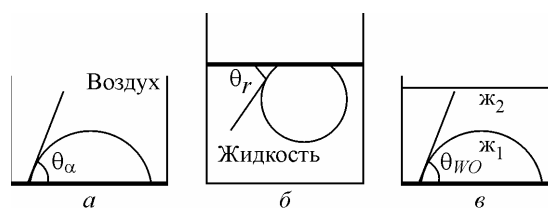
Рис. 1. Схема измерения краевых углов в условиях натекания (а), оттекания (б) и избирательного смачивания (в)
