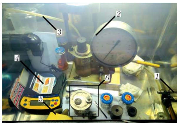
Рис. 2. Общий вид установки для получения компактных образцов изделия внутри герметичного бокса:
