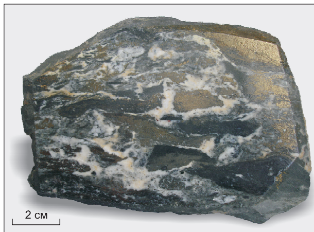
Рис. 7. Рудная брекчия, сложенная обломками руд и вмещающих пород.
