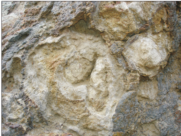
Рис. 6. Трубообразные сульфидные тела в кремнистой оболочке — рудоподводящие каналы в основании главного рудного тела.
