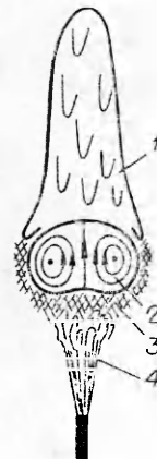
Рис. 3. Схема взаимодействия вихревого кольца с факелом. 1 — фронт пламени; 2 — вихревое кольцо; 3 — газообразные продукты сгорания; 4 — струя топлива.
