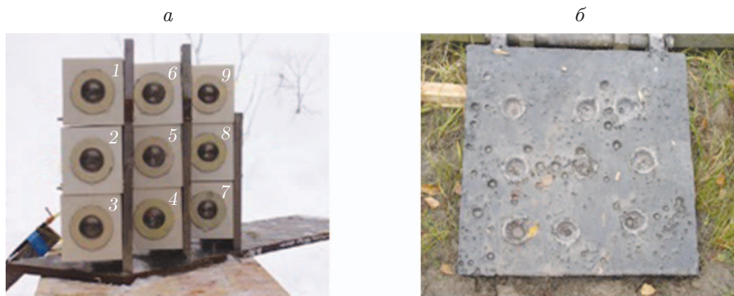
Рис. 4. Сборка с взрывными метаяющими устройствами (а) и плита-мишень после воздействия поля КЭ (б): 1-9 — ВМУ
