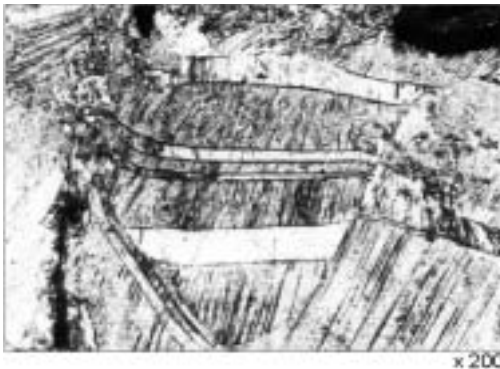
Рис. 2. Микроструктура компакта медного сплава из порошка с d_{cp} = 600 мкм, на котором область R измерена по изгибу двойников
