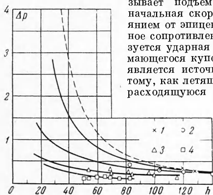
Фиг. 4. Зависимость избыточного давления \Delta p кг/см 2 в воздушной ударной волне от приведенного расстояния h = R/R_0 для разных глубин погружения заряда (данные полигонных опытов отмечены точками) кривые и точки 1, 2, 3, 4 соответствуют глубинам погружения заряда H=0, 1, 2, 3 . Пунктирная кривая — наземный взрыв заряда в воздухе
