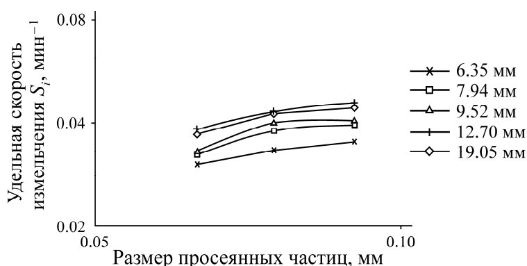
Рис. 3. Изменение удельной скорости измельчения при использовании шаров разного диаметра для сухого помола нефелинового сиенита ( D=0.15 м, J=0.30 , U=1 )
