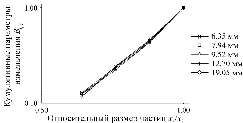
Рис. 4. Кумулятивная функция распределения измельчения при использовании шаров разного диаметра
