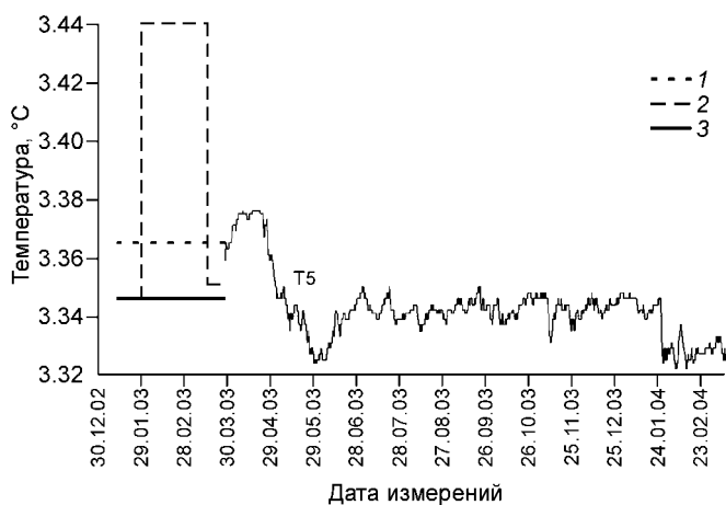
Рис. 8. Модели изменения поверхностной температуры (на уровне датчика T5, см. рис. 5) в период перед началом мониторинга, рассмотренные при выполнении математического моделирования.
