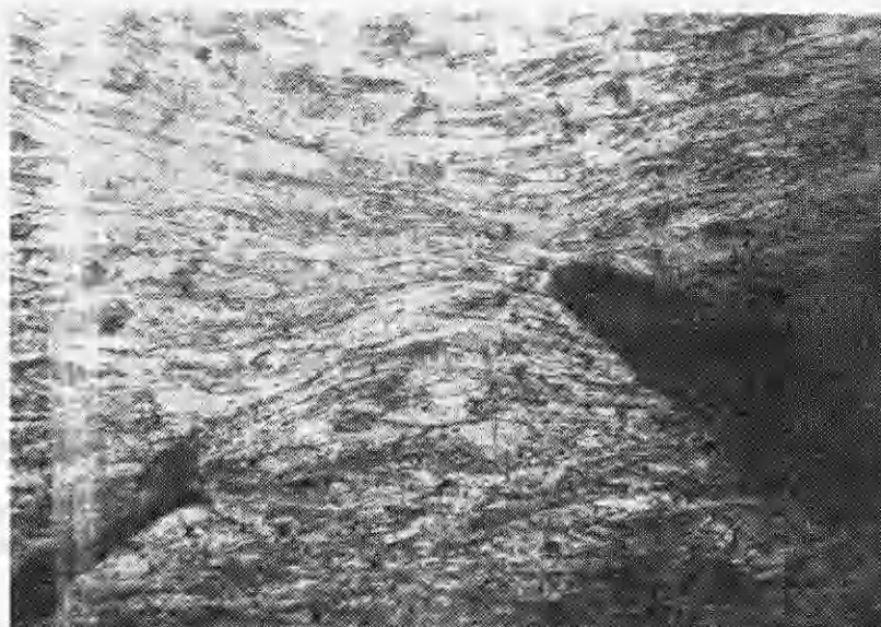
Рис. 2. Армко-железо, нагружение октогеном, \dot{\epsilon} = 5 \cdot 10^4 \text{ с}^{-1} , \epsilon = 150\% ( \times 100 ); интенсивные полосы сдвига и трещина у поверхности нагружения с рекристаллизованными зёрнами.
