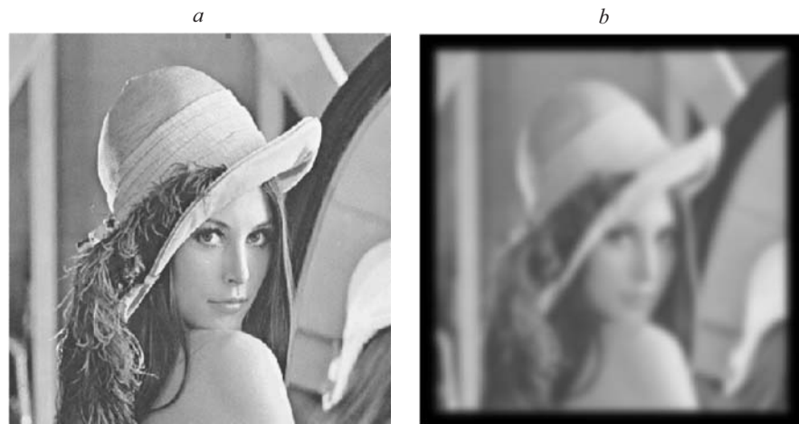
Рис. 1. «Точные» изображения: исходное \varphi(\tau_1, \tau_2) ( a ) и выходное (зарегистрированное без шума) f(t_1, t_2) ( b )
