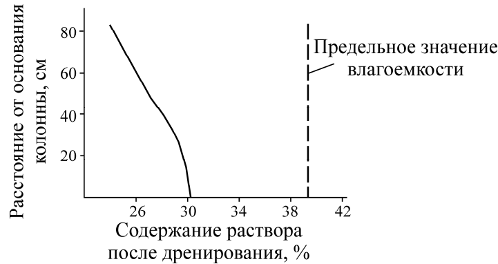
Рис. 3. Водоудерживающая способность породы на различных уровнях от дна колонны
