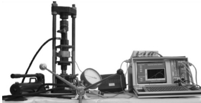
Рис. 2. Полевой приборный комплекс для определения деформационных и прочностных свойств горных пород при испытании керна
