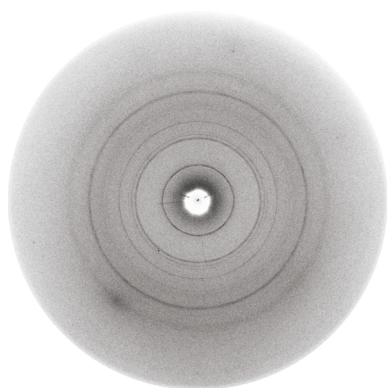
Рис. 1. Дебаграмма 10 \text{ \AA} фазы при 450^\circ\text{C} и 4 \text{ ГПа}
