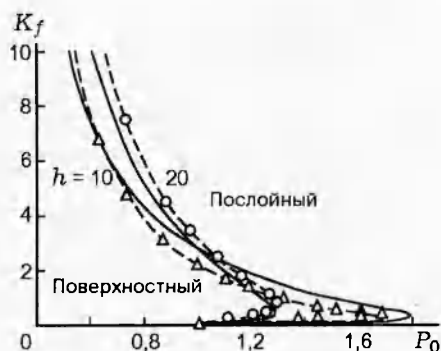
Рис. 1. Области существования послойного и поверхностного режимов горения:
