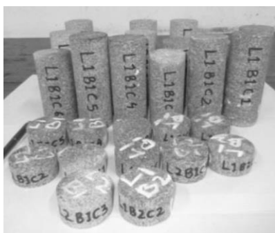
Рис. 3. Подготовленные горные образцы согласно стандартам ISRM
