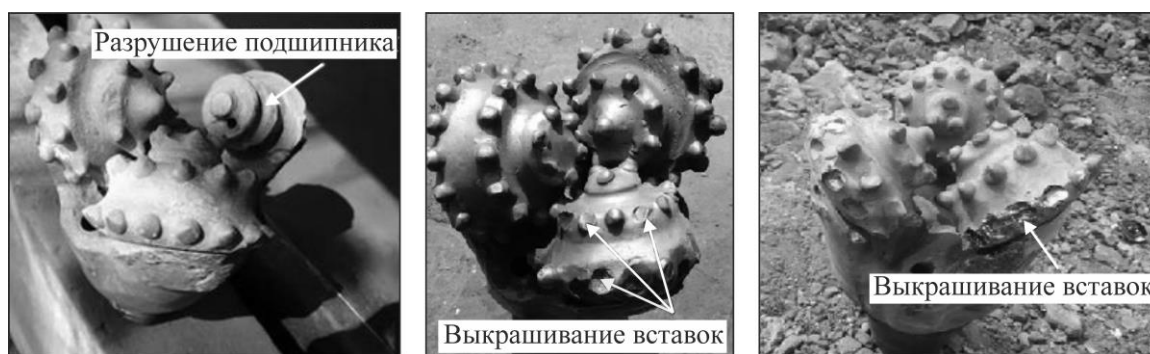
Рис. 2. Типы отказа бурового долота
