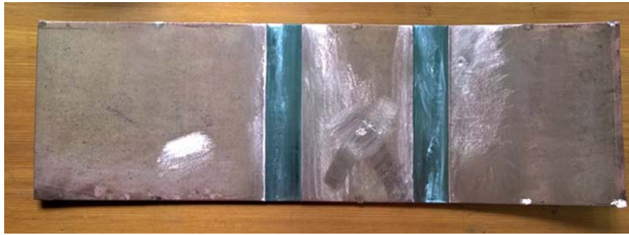
Рис. 1. Вид снизу метаемой пластины из стали 30ХГСА, плакированной медью М1 толщиной 0.5 мм
