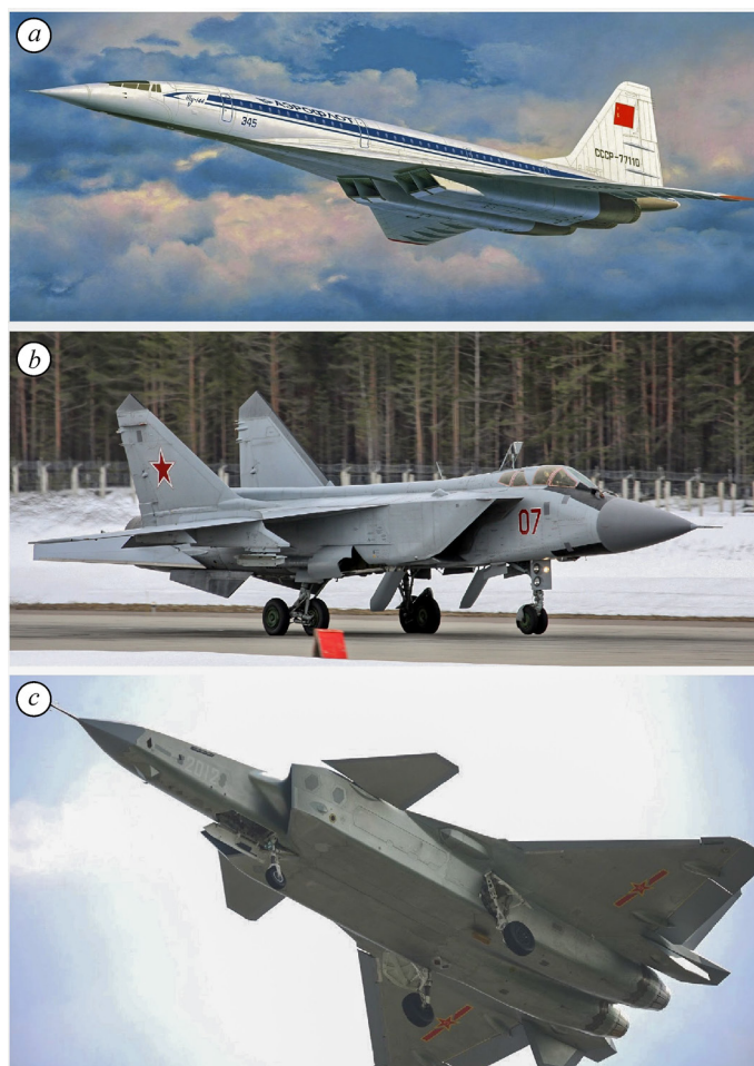
Рис. 1. Сверхзвуковые самолеты с коробчатыми мотогондолами. а — Ту-144 (СССР, первый полет — 31.12.1968), б — МиГ-31 (СССР, 16.09.1975), в — Chengdu J20 (КНР, 11.01.2011).
