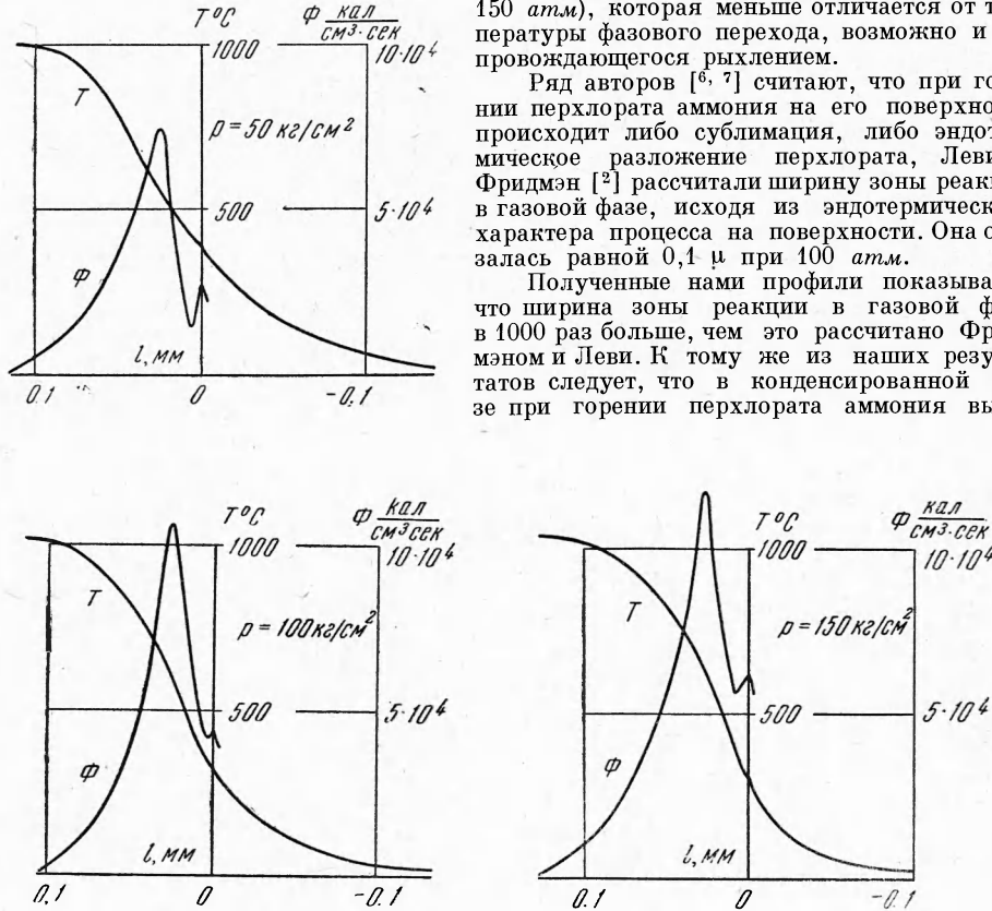
Фиг. 3. Профили температуры и распределение скорости выделения тепла при горении перхлората аммония в стабильной области
