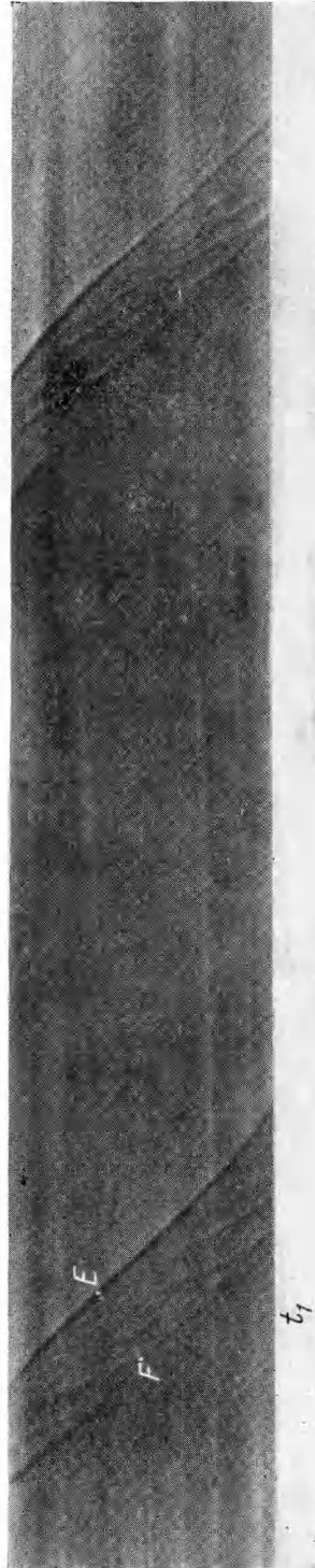
Фиг. 6. Следовой отпечаток синювой детонации (смесь 2\text{H}_2 + \text{O}_2 ; p_0 = 45 мм рт. ст.; d = 16 мм; G = 2 )
