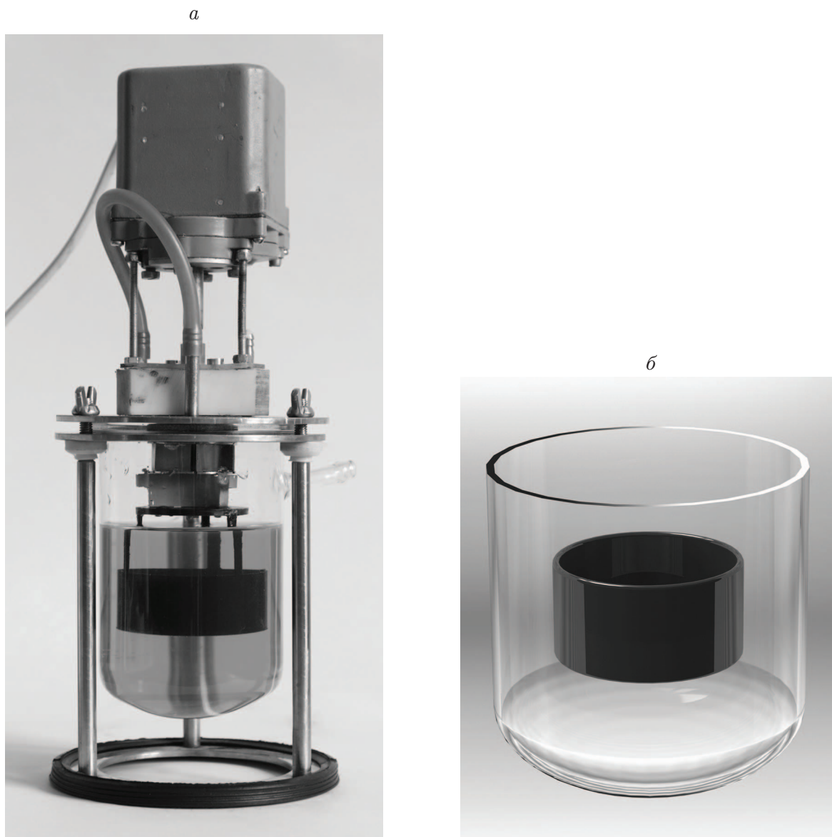
Рис. 1. Ротационный биореактор (а) и его геометрическая модель (б)
