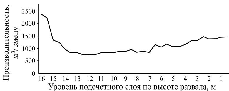
Рис. 3. Зависимость производительности драглайна от высоты развала вскрышных пород
