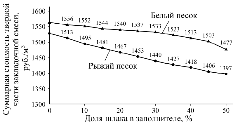
Рис. 2. Суммарная стоимость твердой части (портландцемент, песок, шлак) 1 м 3 закладочной смеси в зависимости от доли шлака в заполнителе
