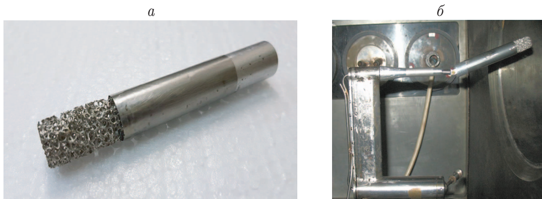
Рис. 1. Модель цилиндра с передней пористой вставкой (а) и весы в рабочей камере аэродинамической трубы с установленной на них моделью (б)
