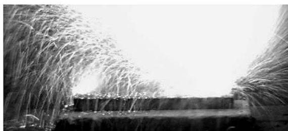
Рис. 3. Характерный вид распространения фронта горения по образцу (3\text{NiO} + 3\text{Al} \rightarrow \text{Ni}_3\text{Al} + \text{Al}_2\text{O}_3)
