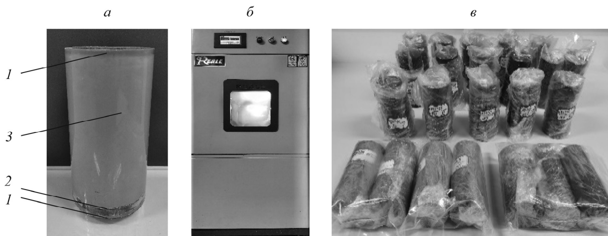
Рис. 4. Размещение пульпы (а), камера с установленной температурой и влажностью (б), образцы смеси (в): 1 — перфорированный камень; 2 — фильтрующая бумага; 3 — акриловая форма
