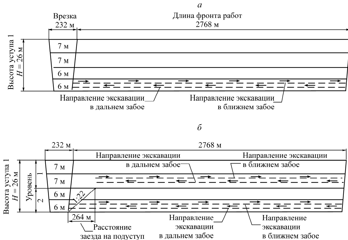
Рис. 3. Схема движения экскаватора в рабочей зоне (вид сбоку): а — вариант без подступов, б — вариант с двумя подступами
