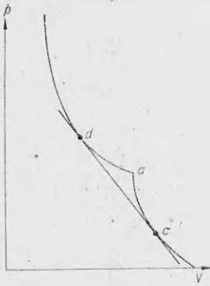
Рис. 3. Адиабата Пуассона среды, претерпевающей фазовый переход первого рода.
