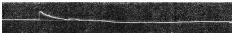
Фиг. 1. Типичная форма записи \Delta p(t) ударной волны от взрыва цилиндрического заряда \Delta p_1 = 0.87 \text{ кг/см}^2
