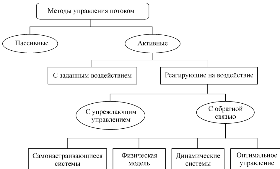
Рис. 2. Схема, иллюстрирующая иерархию управления турбулентным потоком (Lofdahl, 1999).
