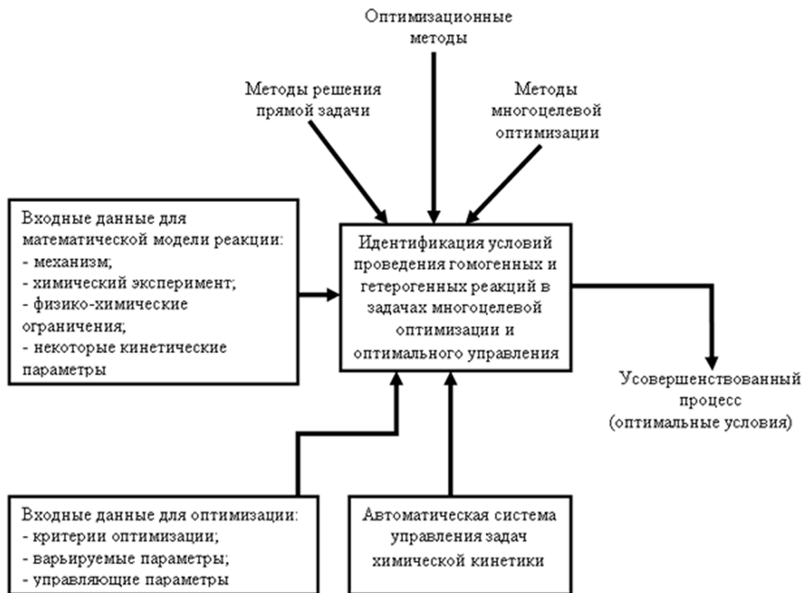
Рис. 1. Контекстная диаграмма идентификации оптимальных условий проведения сложных каталитических реакций
