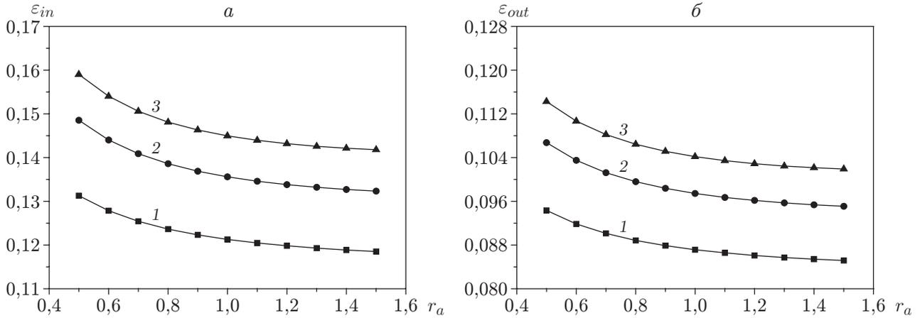
Рис. 3. Зависимости эквивалентной деформации на внутренней (а) и внешней (б) поверхностях сосуда от параметра анизотропии  $r_a$  при  $\varkappa = 1,2$ ,  $n = 0,2$ :
