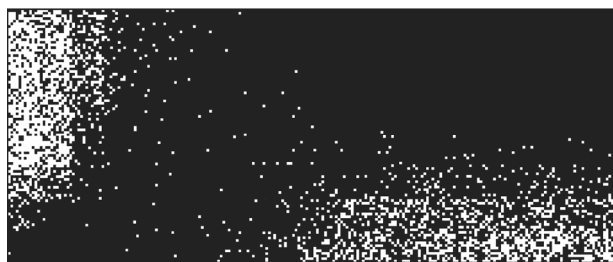
Рис. 4. Возможная картина техногенной нарушенности левой части разделительного целика при \alpha = 1 . Нарушенные блоки показаны черным цветом
