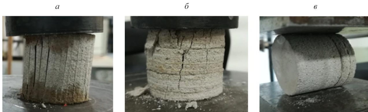
Рис. 2. Механические испытания кернов, выбуренных из модели, изготовленной по схеме рис. 1б: а, б — одноосное сжатие вдоль и поперек напластования соответственно; в — испытания керна, выбуренного поперек слоистости, по схеме бразильского теста
