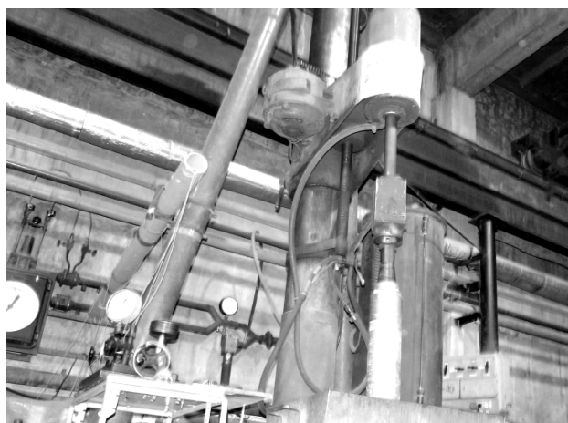
Рис. 2. Стенд ГД-251 с пневмоударником ПВ 170
