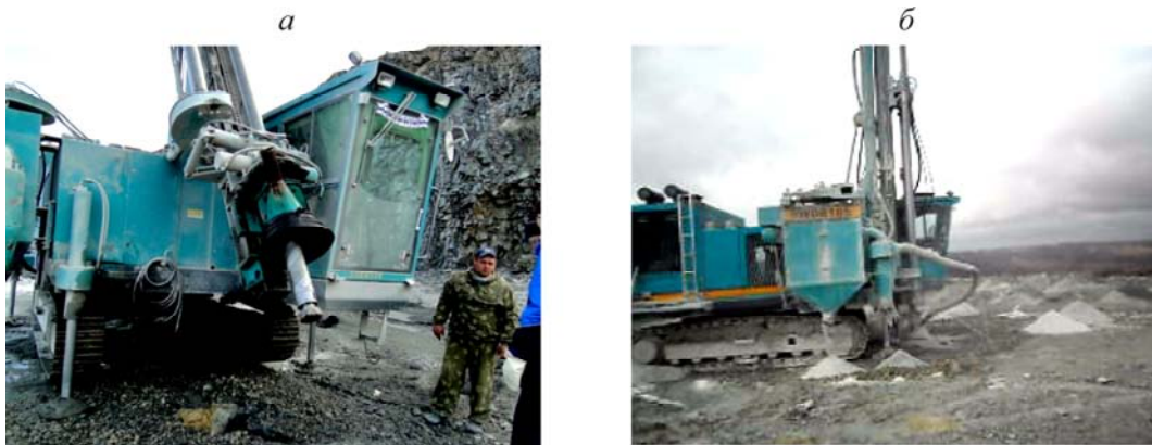
Рис. 6. Пневмударник ПВ 170М на буровом станке SWDB165 на карьере “Борок” г. Новосибирска (а) и на Коенском карьере (б)
