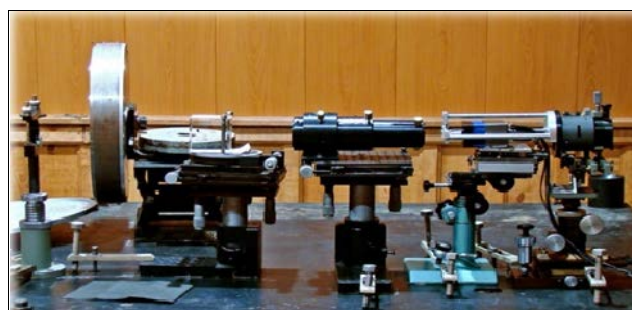
Рис. 5. Корреляционный датчик Шака-Гартмана системы коррекции
