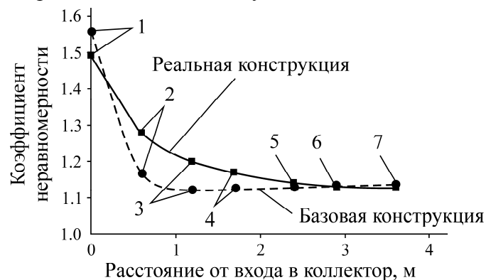
Рис. 5. Изменение коэффициента неравномерности течения воздушного потока по мере удаленности от входа в коллектор: 1–7 — характерные сечения
