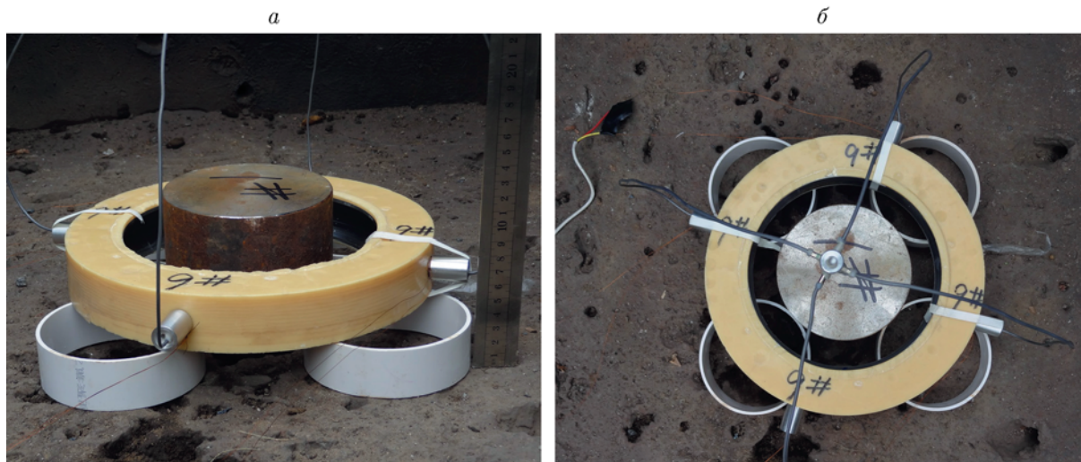
Рис. 7. Устройство для проведения испытаний по резке
