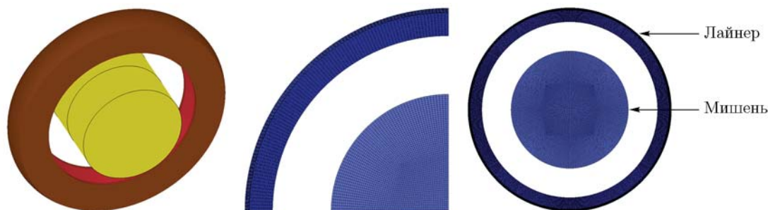
Рис. 2. Конечная модель кольцевого КЗ и стального цилиндра в качестве мишени
