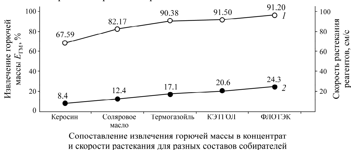
Рис. 3 Извлечение горючей массы в концентрат (1) и скорость растекания флотационных реагентов-собирателей (2)
