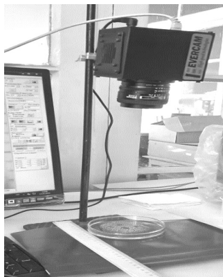
Рис. 1. Установка по определению скорости растекания аполярных и гетерополярных реагентов-собирающих по поверхности воды
