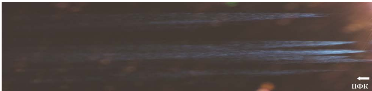
Рис. 4. Множественная филаментация в стекле К8 при воздействии ПФК на расстоянии 90 м от конца области филаментации. Рисунок заимствован из [8]
